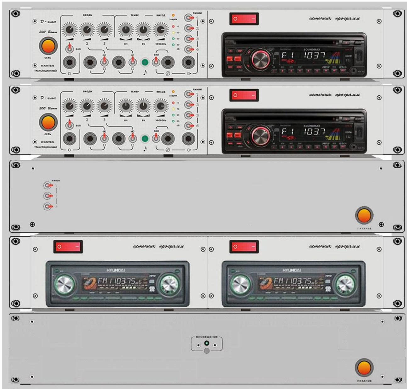
На передней панели (начиная с верхнего блока — трансляционное устройство **ТУ 100С/ТУ 200С**) расположены следующие органы управления, коммутации и подключения к внешним устройствам (показаны в «рабочем положении» слева на право):
