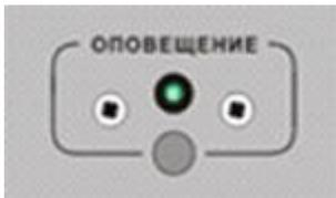
Кнопка включения приоритетного сигнала «оповещение» трансляционного усилителя РУШ 650 Р
