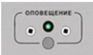
Кнопка включения приоритетного сигнала «оповещение» трансляционного усилителя РУШ 650 Р служит для подачи в приоритетном режиме по всем каналам сигнала «оповещение».
