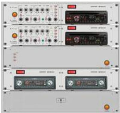
1. Трансляционное устройство ТУ 100 С/ТУ 200 С (ДЛЭ2.465332.100.00 ТУ/ДЛЭ2.465332.200.00 ТУ) формирования первой программы вещания на базе трансляционного усилителя РУШ 6100М/РУШ 5М (ТУ 6573-100-07529494-99) и источника программ РУШ 650И (ТУ 6573-100-07529494-99) — 1 шт.
