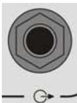
Линейный выход обеспечивает возможность записи и каскадного включения, что дает увеличение мощности и количества зон вещания. Для этого необходимо линейный выход первого усилителя соединить с одним из линейных входов — второго усилителя, далее линейный выход второго соединить с линейным входом третьего усилителя и т.д.
