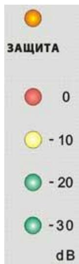
Индикатор перегрузки (защита) загорается, когда уровень выходного сигнала на терминалах подключения трансляционных линий 1-4 (30/100/120 В) достигает максимального значения.
