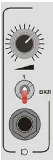
Секция, относящаяся к микрофонному усилителю (входу) 1.
