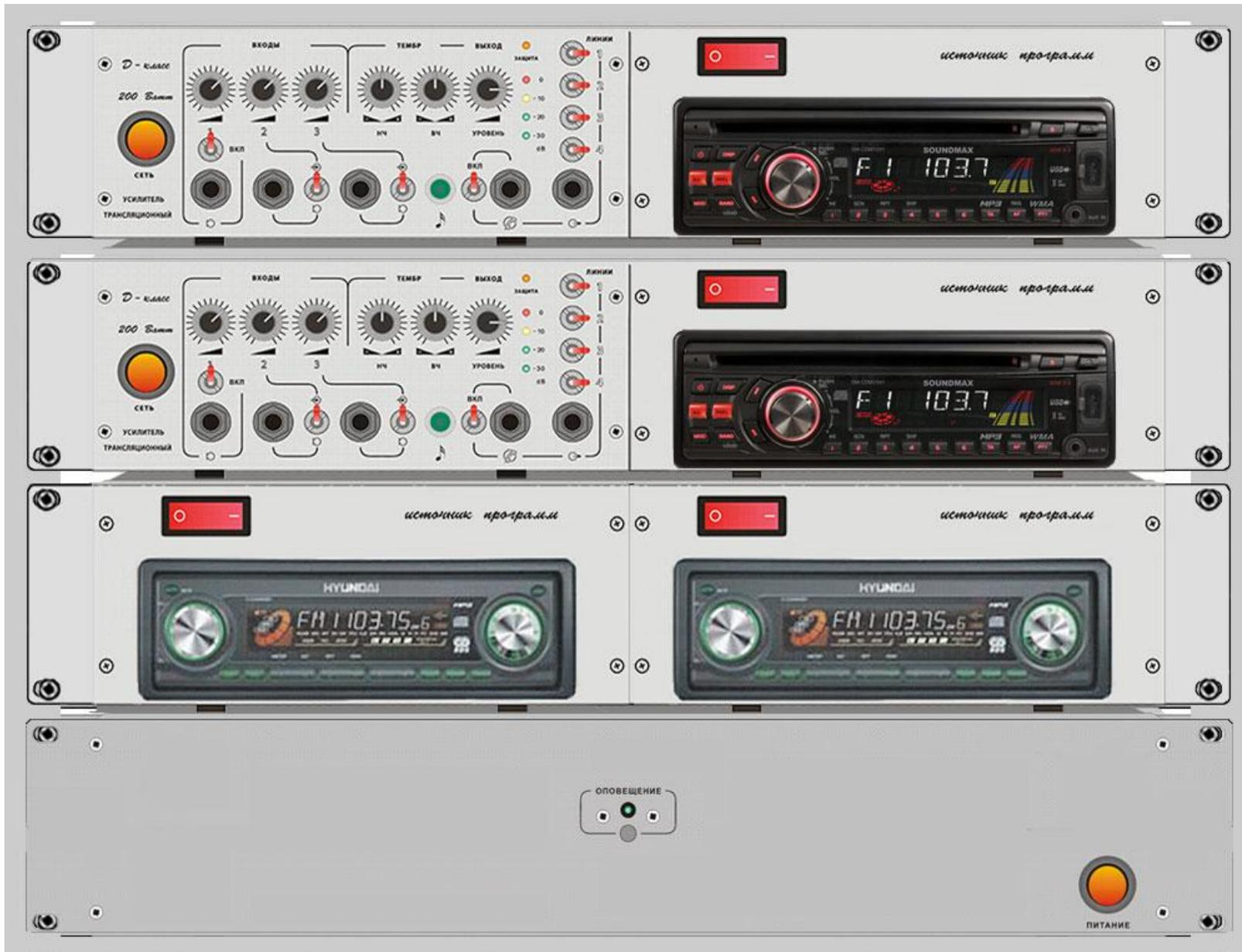
На передней панели (начиная с верхнего блока — трансляционное устройство **ТУ 100С/ТУ 200С**) расположены следующие органы управления, коммутации и подключения к внешним устройствам (показаны в «рабочем положении» слева на право):
