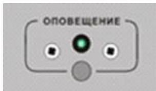
Кнопка включения приоритетного сигнала «оповещение» трансляционного усилителя РУШ 650 Р служит для подачи в приоритетном режиме по всем каналам сигнала «оповещение».
